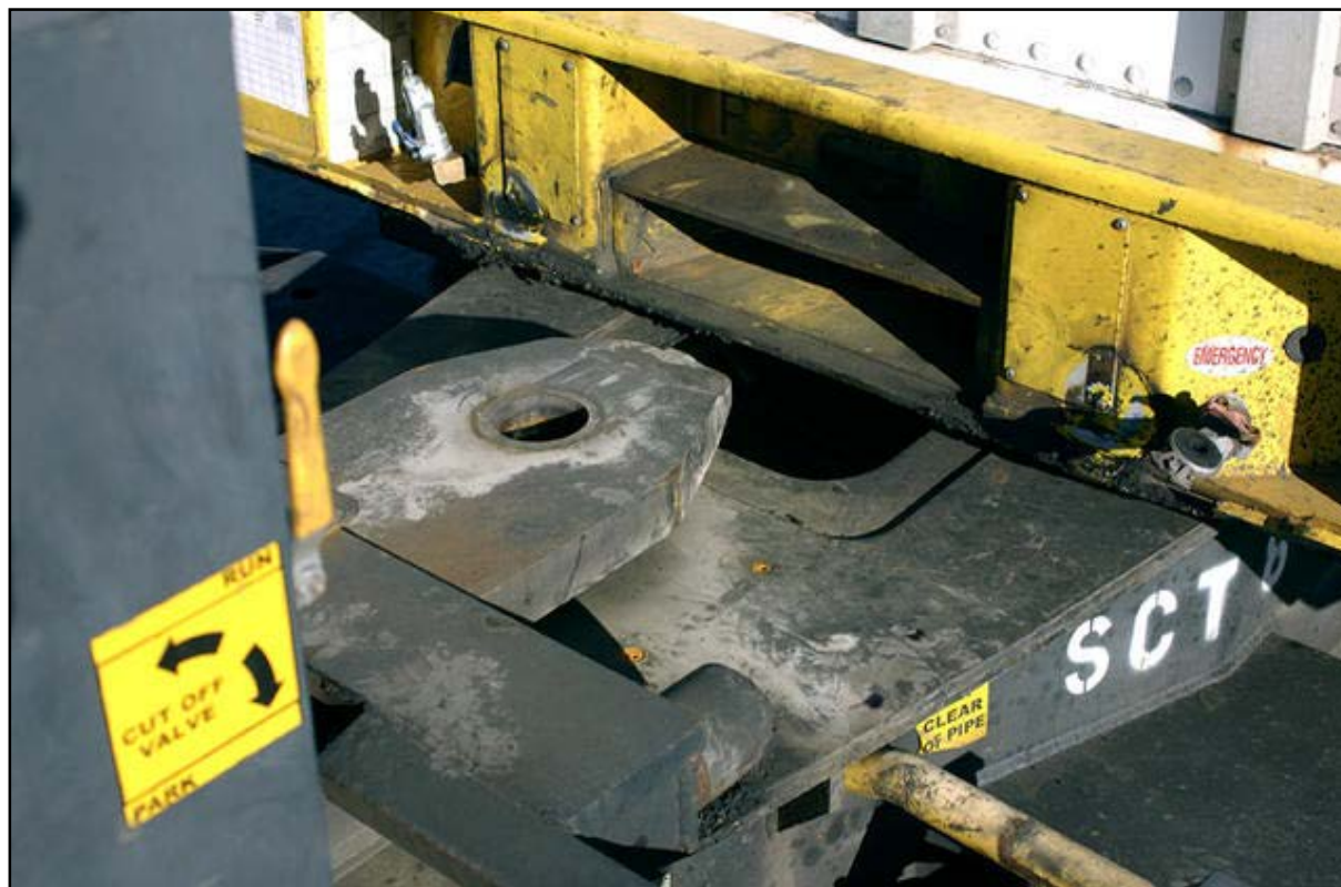
Posicionamiento de la unidad de transición debajo del chasis
