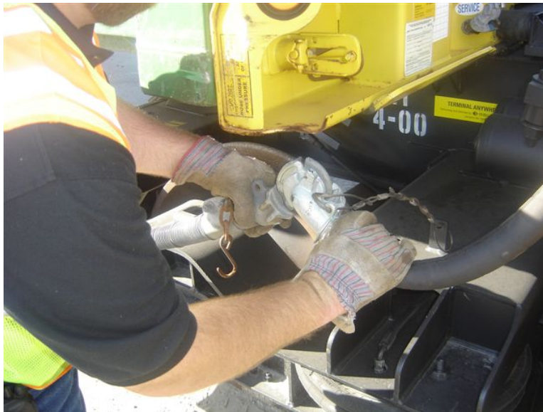
Figura 28 Conecte la tubería de aire del tren.
