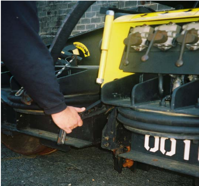
Figura 29 Vista del freno de mano y de la caja de control de la unidad intermedia.
