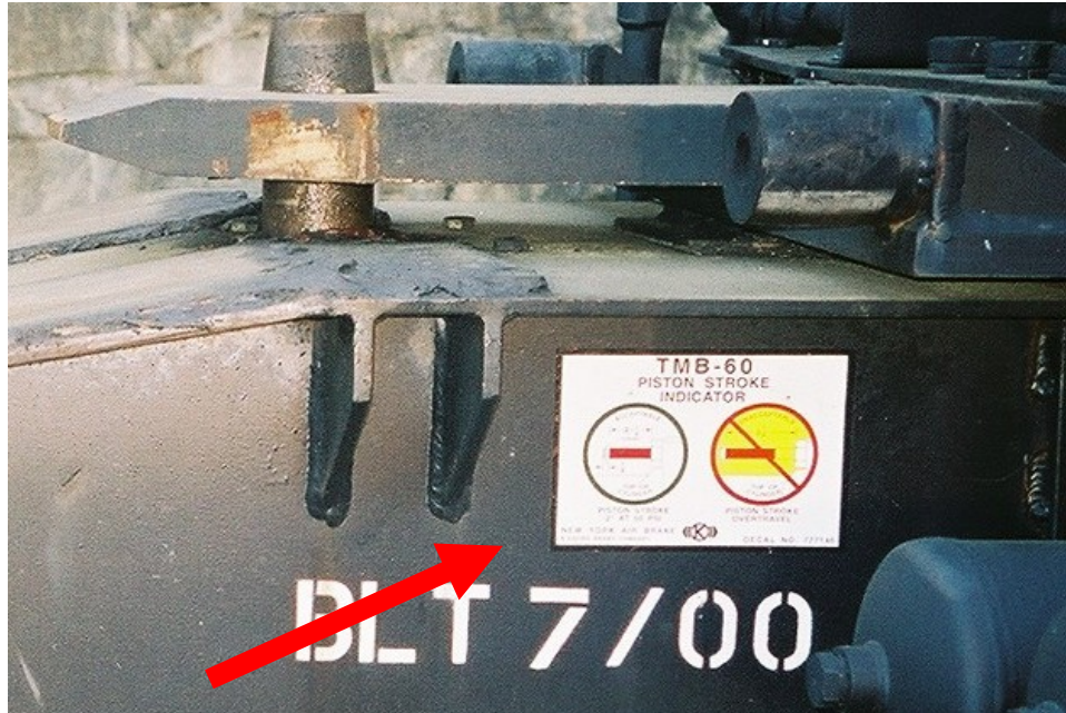
Figura 45 Calcomanía de instrucciones del pistón NYAB TMB-60
