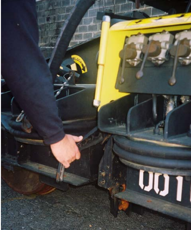
Figura 10 Aplicando el freno de mano
