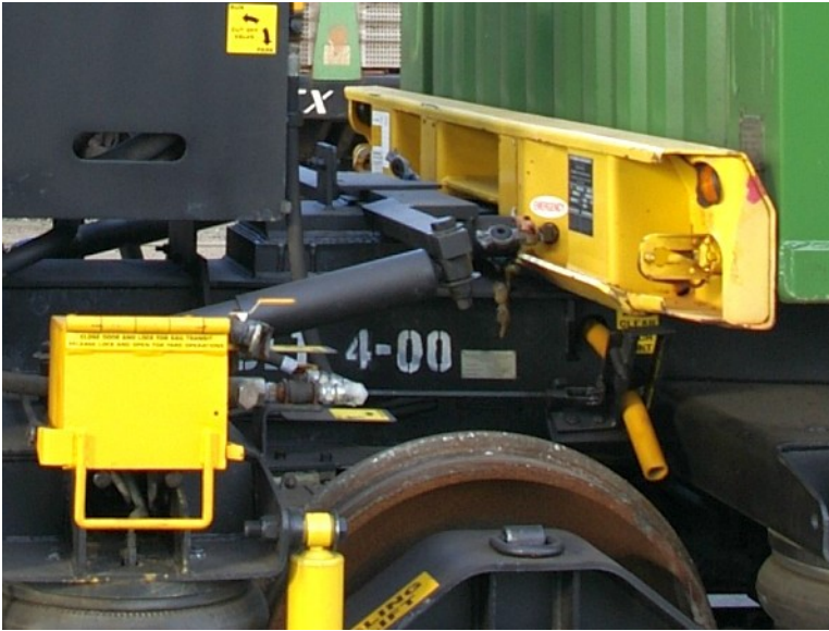
Figura 27 El receptor del chasis engancha completamente con la barra de tracción.
