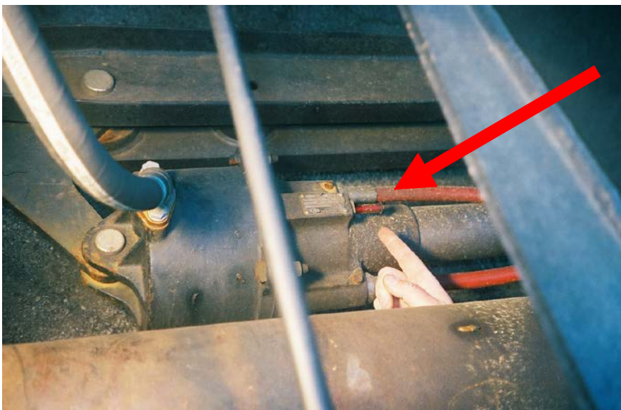
Figura 13 Indicador del pistón del freno NYAB TMB-60
