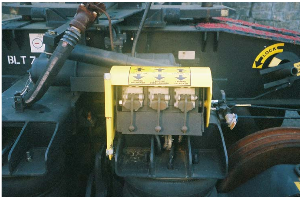
Figura 9 Caja de control en posición abierta (Cierre de control, manivela e instrucciones)
