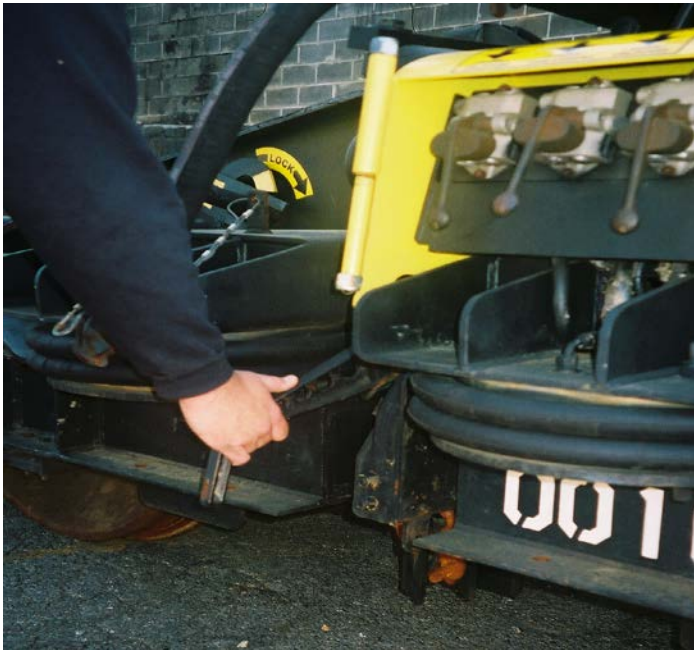
Figura 53 Vista del freno de mano y de la caja de control de la unidad intermedia
