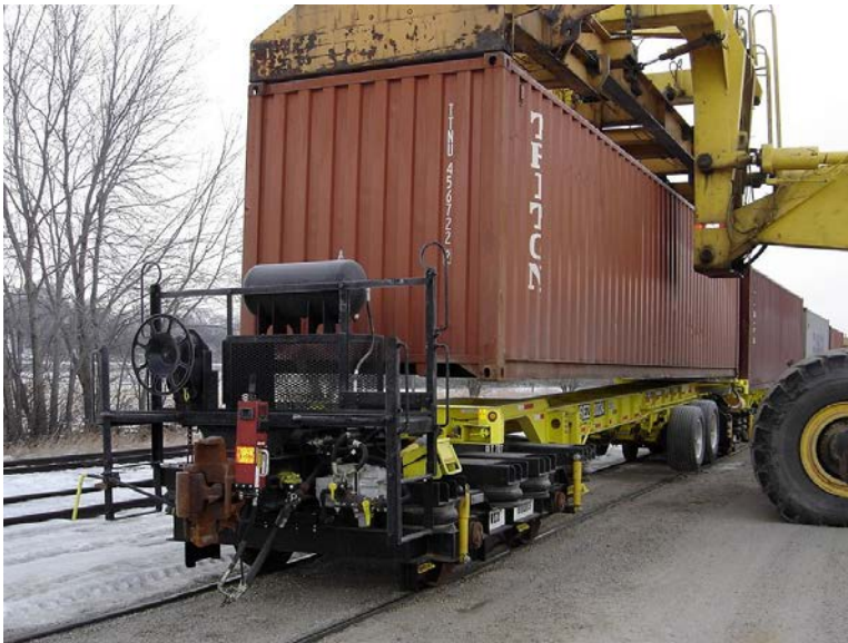
Figura 65 Montacargas para maquinaria pesada cargando un contenedor en un chasis posicionado
