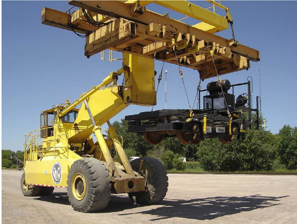
Figura 68 Montacargas para maquinaria pesada llevando una Unidad de Transición
