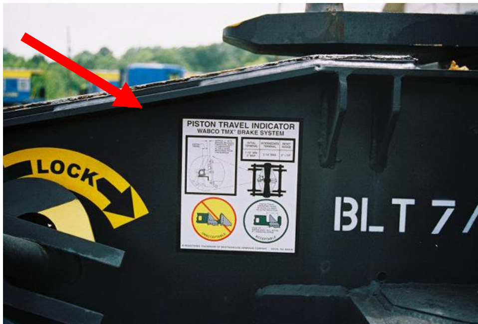
Figura 44 Calcomanía de instrucciones del Indicador del Freno Wabco TMX
