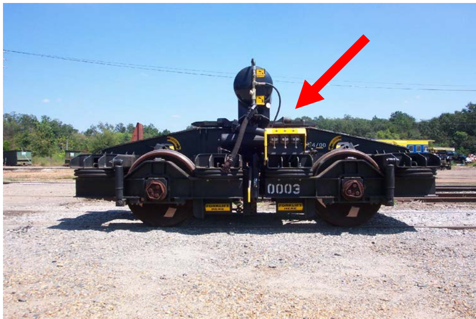
Figura 7 Vista de la caja de control de la unidad intermedia
