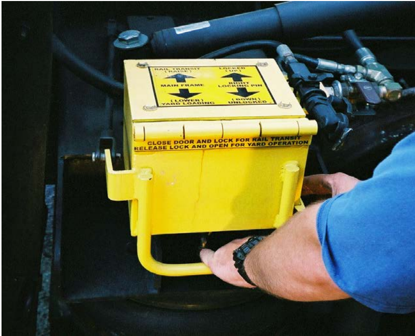
Figura 39 Cerrando la caja de control de la Unidad de Transición
