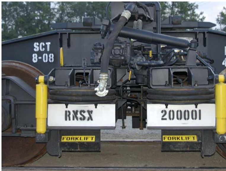
Figura 62 Cavidades para las uñas del montacargas
