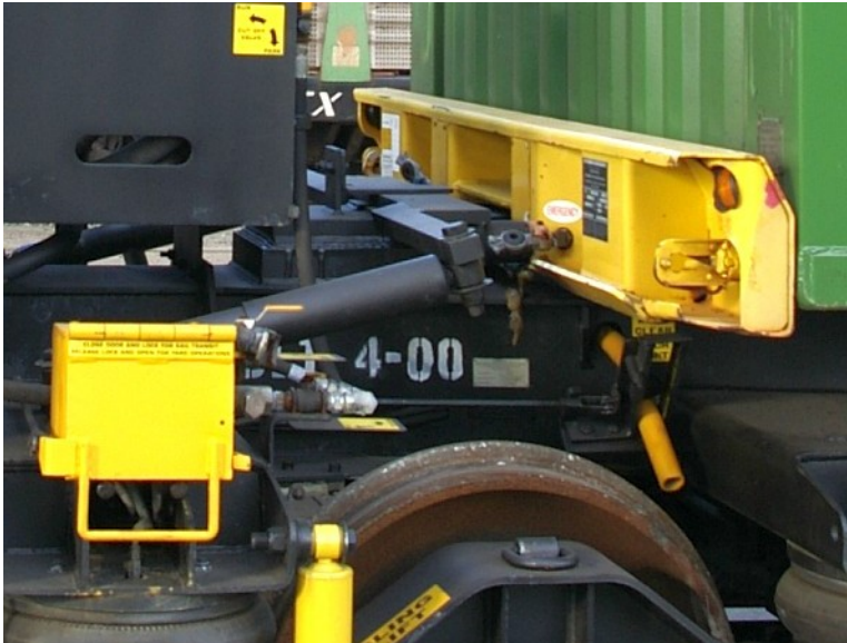
Figura 51 Recibidor de chasis completamente enganchado a la barra de enganche
