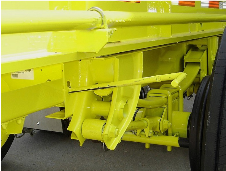
Figura 74 Palanca de control de la suspensión en posición “ABIERTA”
