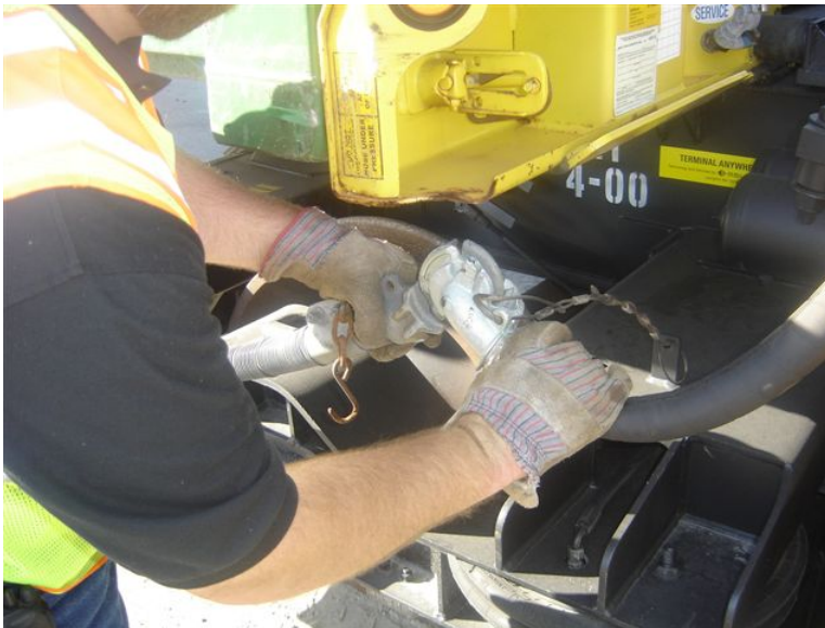
Figura 52 Conexión de la tubería de aire del tren
