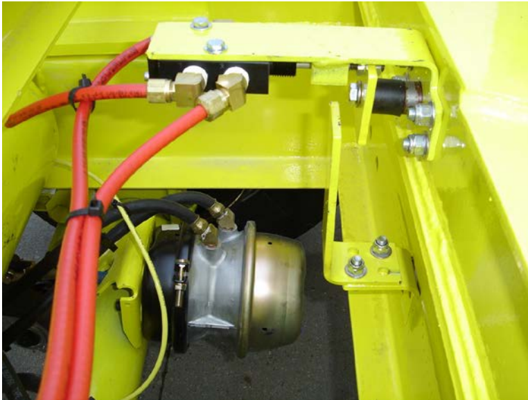
Figura 72 Bloqueo de frenos Riel-a-carretera
