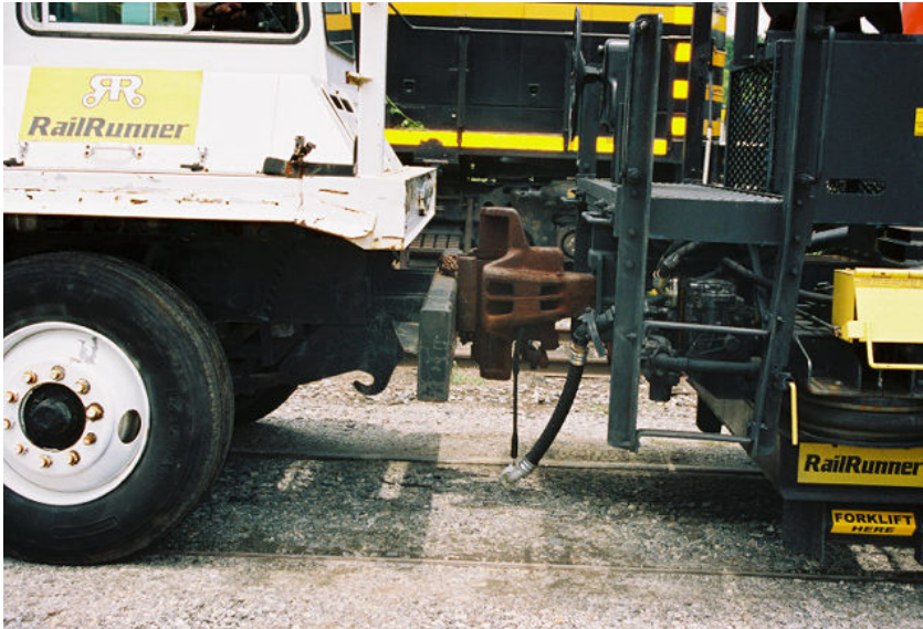
Figura 49 Empujando la unidad de transición debajo del frente de chasis
