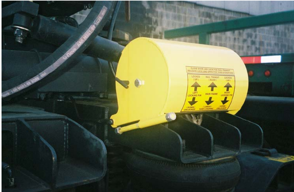
Figura 8 Caja de control en posición cerrada (Cierre de control, manivela e instrucciones)
