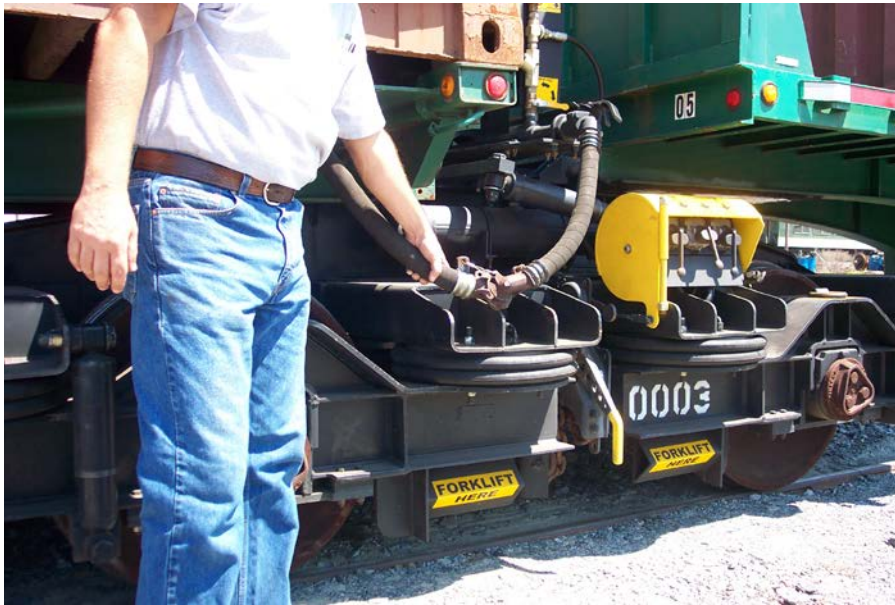
Figura 59 Conexión de la tubería de aire del tren
