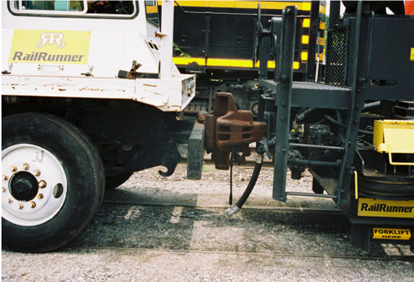
Figura 25 Empujando la unidad de transición debajo del frente del chasis
