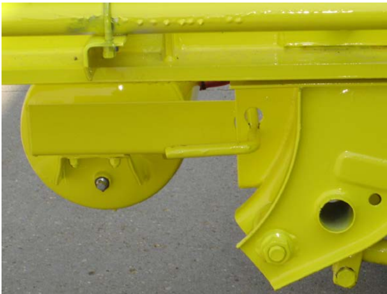
Figura 75 Palanca de control de la suspensión enganchada en la ranura en posición “CERRADA”
