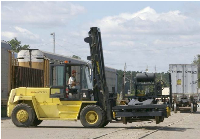
Figura 63 Levantamiento de un bogie UT con montacargas
