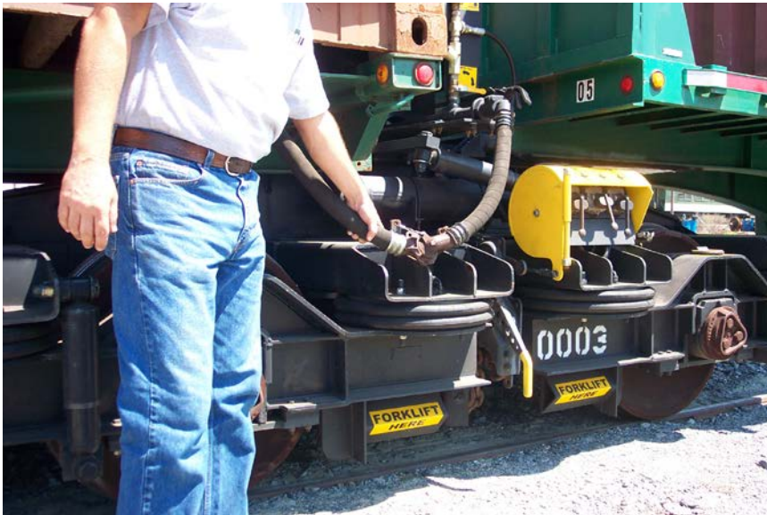
Figura 35 Conectando la tubería de aire del tren.
