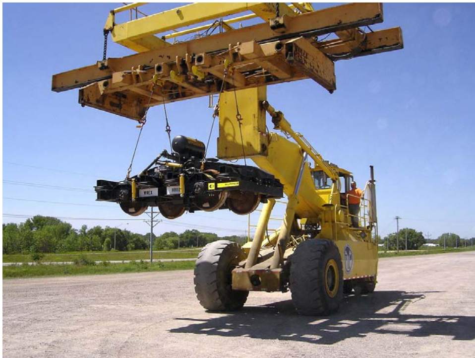
Figura 67 Montacargas para maquinaria pesada llevando una Unidad Intermedia.
