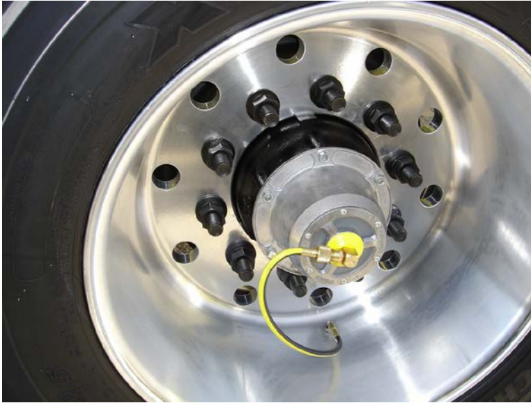
Figura 80 Sistema para inflar llantas
