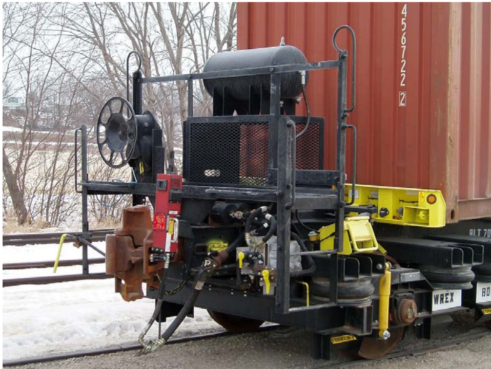
Figura 46 Dispositivo DET instalado en la unidad de transición Posterior/de empuje
