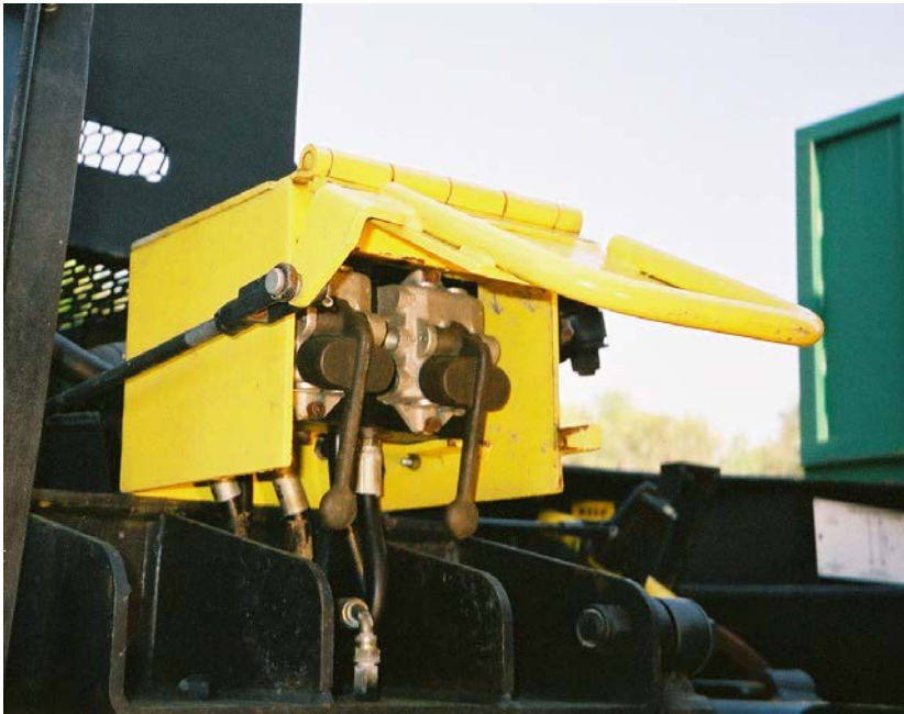
Figura 38 Activación de los controles de la unidad de transición.
