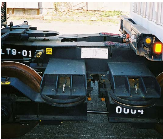
Figura 50 Posicionamiento de la unidad de transición debajo del chasis
