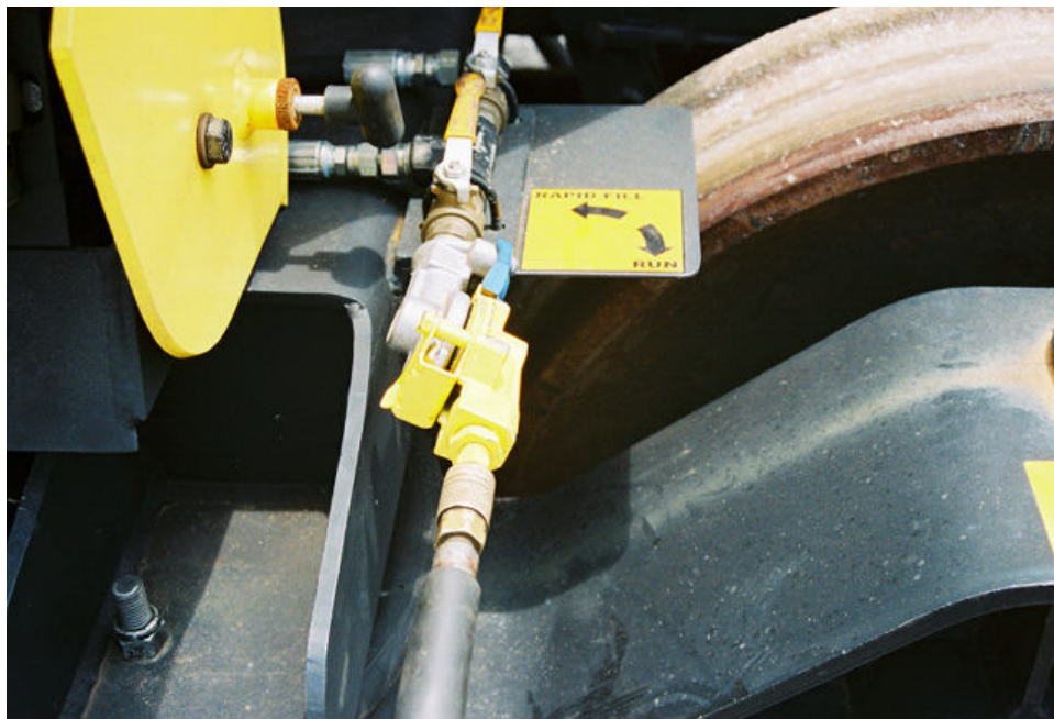
Figura 37 Glad-hand del compresor acoplado a glad-hand en el bogie. Coloque la válvula de bola en “Llenado rápido”. Cargue la reserva de aire a 110 psi.
