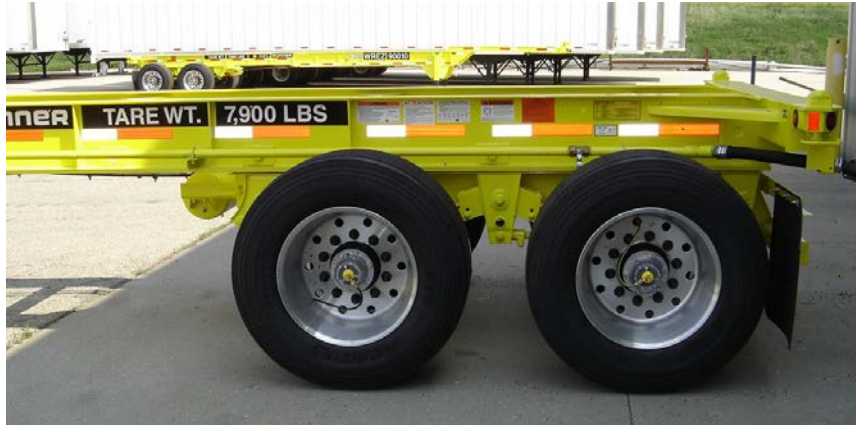
Figura 70 Chasis con suspensión deslizable en la parte posterior para operación en carretera
