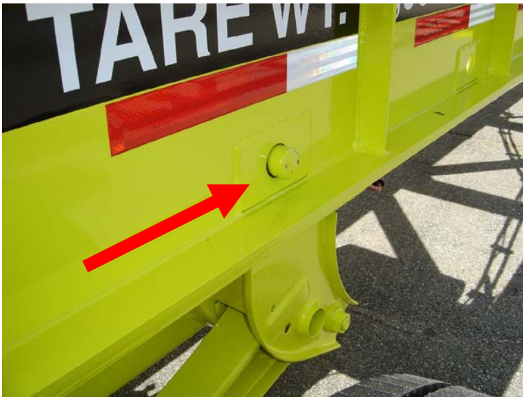
Figura 77 El pasador de cierre de la suspensión está en la correcta posición de cierre
