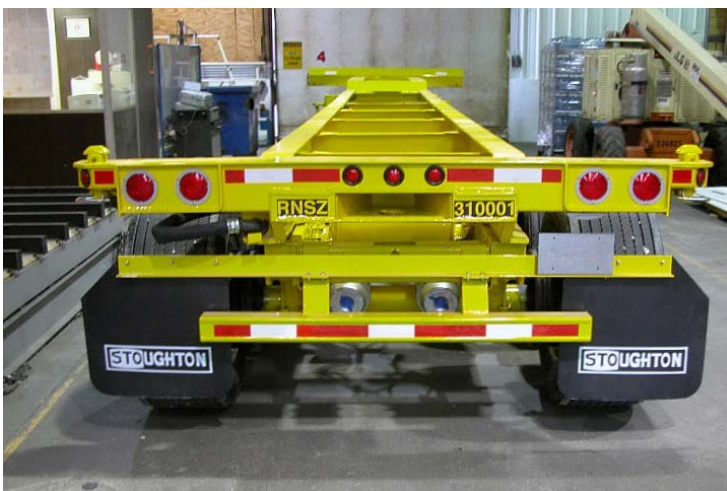
Figura 5 Vista posterior de un chasis RailRunner de 40 pies con la defensa fija a la suspensión
