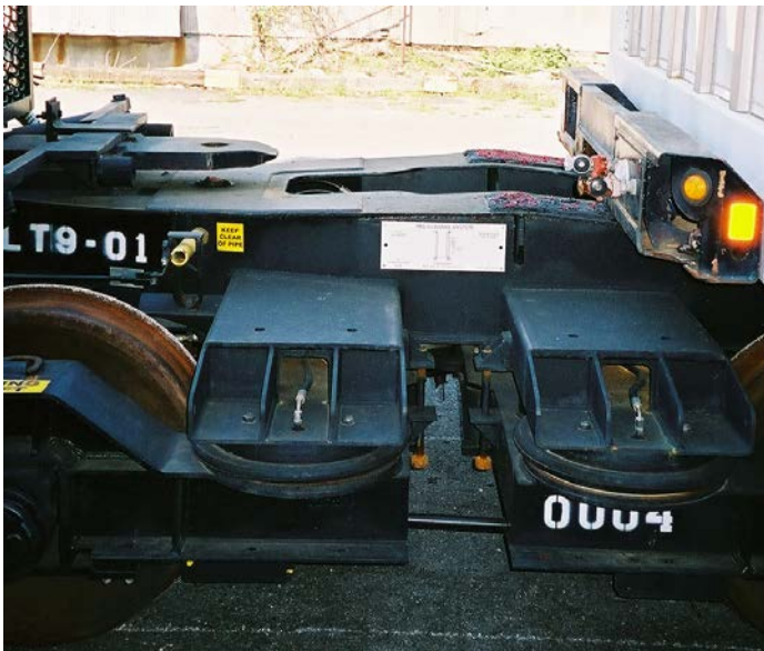
Figura 26 Posicionamiento de la unidad de transición debajo del chasis
