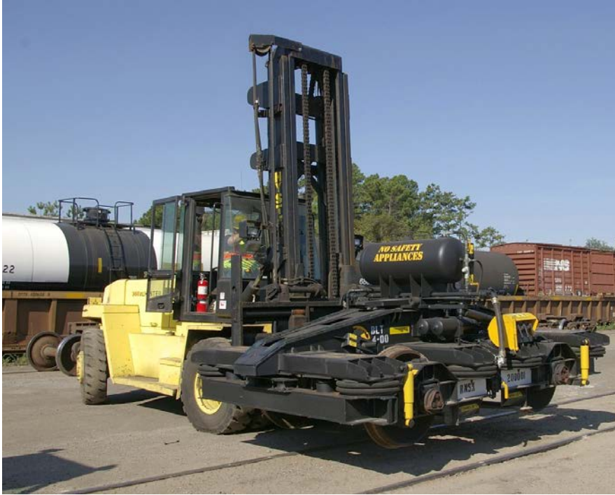
Figura 64 Levantamiento de un bogie UI con montacargas.
