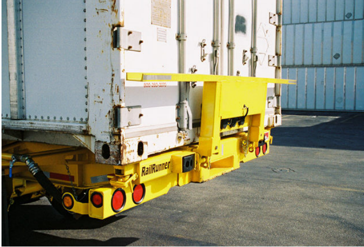
Figura 3 Vista posterior de un chasis RailRunner de 53 pies con Defensa ICC elevada
