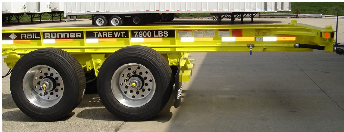
Figura 71 Chasis con suspensión deslizable al frente para operación sobre rieles
