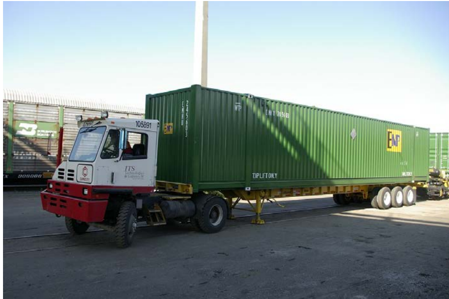
Figura 54 Tracto móvil de patio posicionando un chasis en los rieles para construcción de un tren
