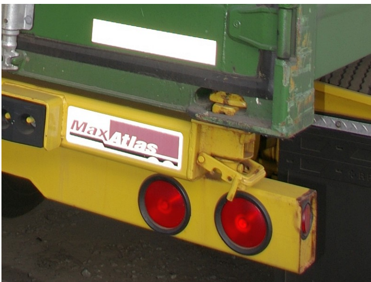
Figura 66 Cierre de rosca enganchado en el chasis en la esquina del contenedor
