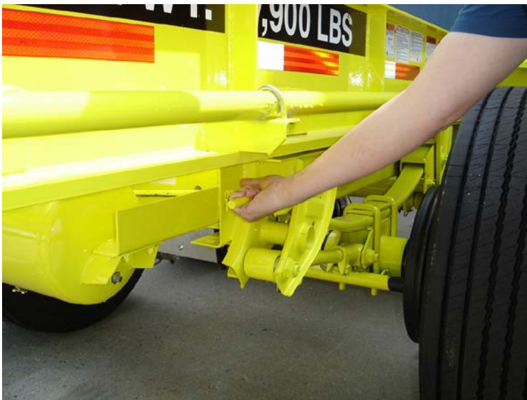
Figura 73 Operación de la palanca de control de la suspensión
