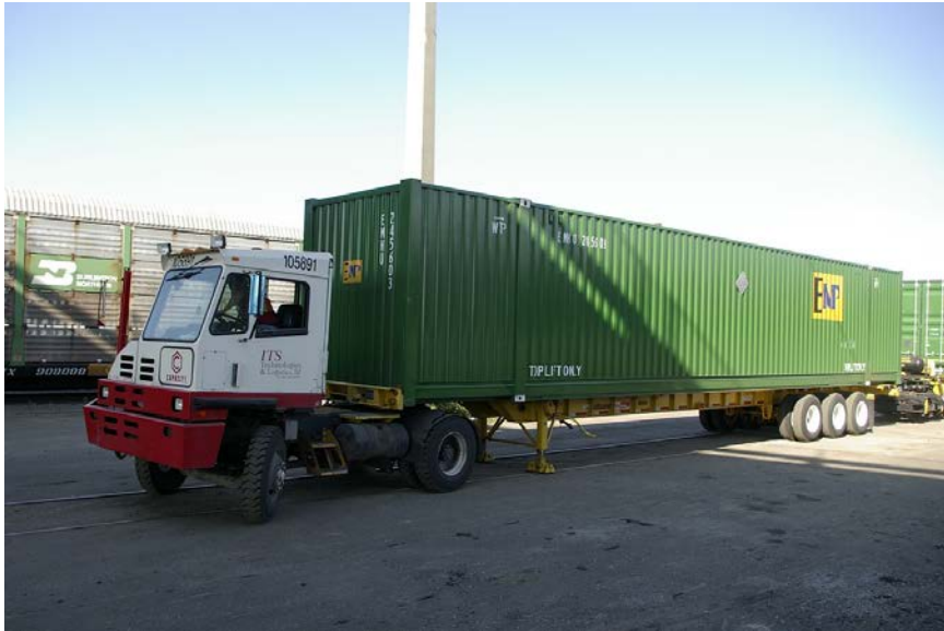
Figura 30 Tracto móvil de patio posicionando un chasis en el riel para la construcción de un tren.
