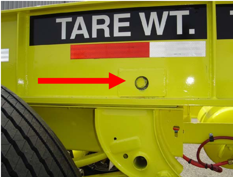
Figura 76 El pasador de cierre de la suspensión no está lo suficientemente extendido a través del marco lateral y NO está enganchado y cerrado correctamente
